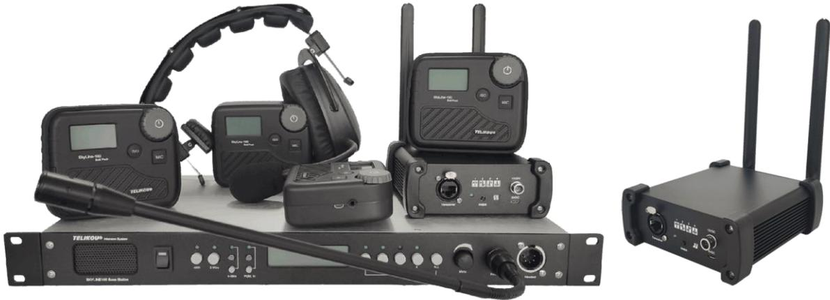
El sistema no es solo un equipo inalámbrico de comunicación en grupo, dúplex completo, sino también una interfaz inalámbrica para conectarse a intercomunicadores por cable de 2 ó 4 hilos. El sistema es adecuado para ocasiones en las que se requiere comunicación móvil, como estaciones TV, centros de comunicación, OB Van, conciertos en vivo y sitios de prueba de ingeniería.
