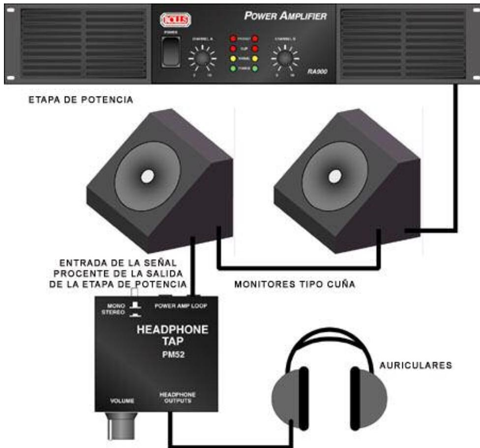
Conecte la señal de salida auxiliar o de monitores de su mezclador a la entrada de señal de su etapa de potencia de monitores.
