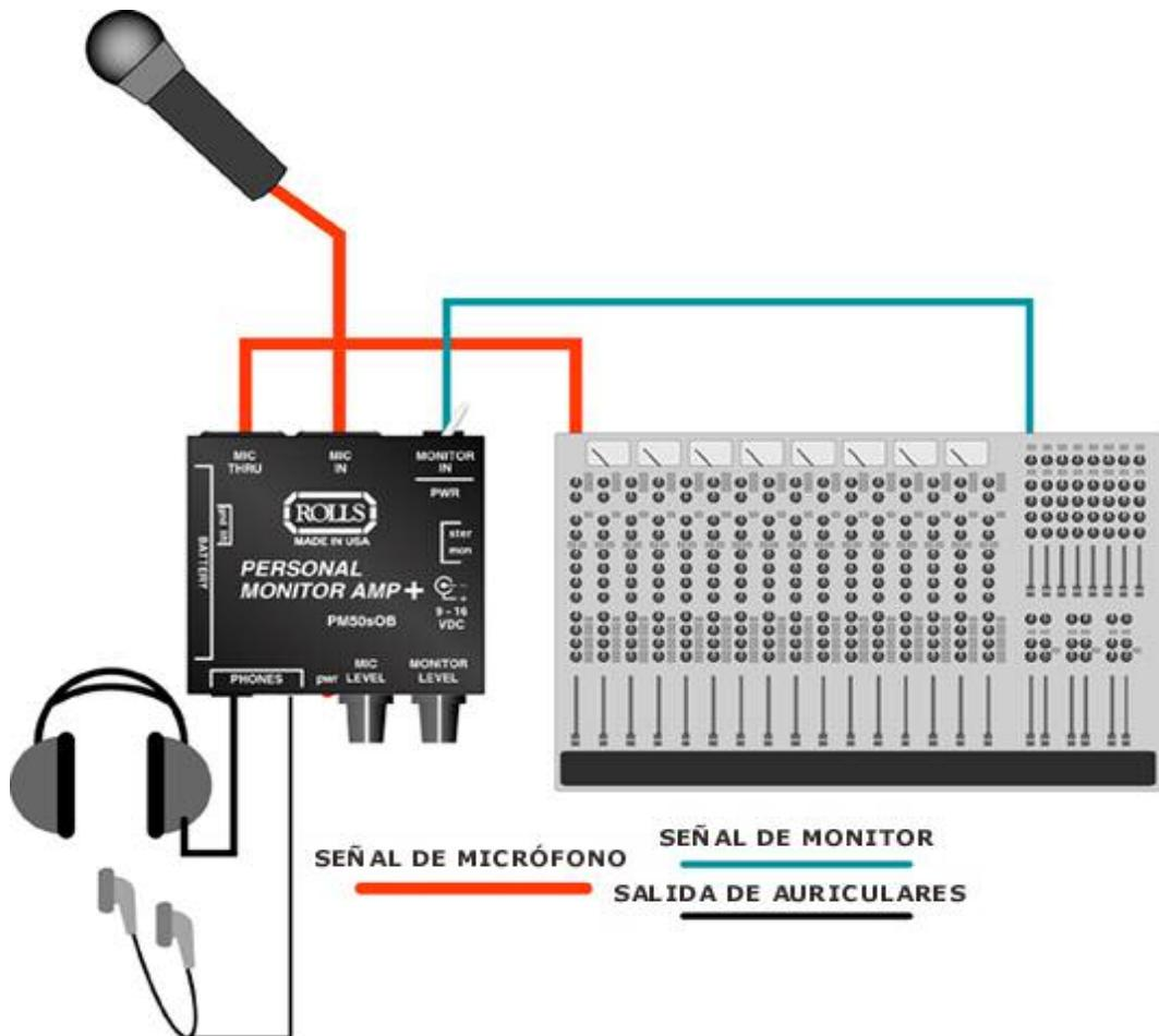
Conecte su micrófono (dinámico o de condensador, El PM50 deja pasar la alimentación Phantom) a la entrada de micro, y de la toma de "Mic Thru" a una entrada del mezclador.
