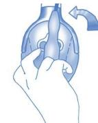
El micrófono se silencia automáticamente cuando el brazo está en posición "Vertical".
